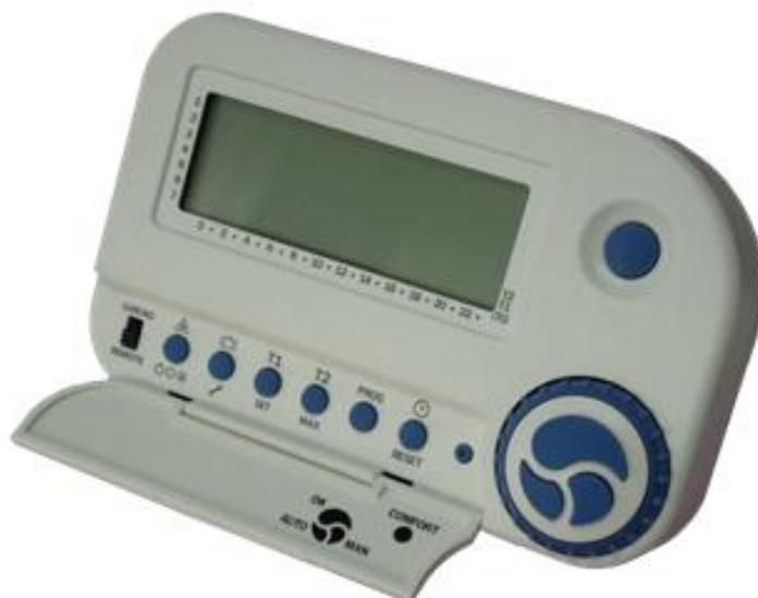
La commande à distance encrono est équipée d'une sonde interne qui permet la lecture de la température ambiante et donc la régulation des appareils. Elle est dotée d'un programmateur hebdomadaire à trois niveaux de sélection de température en fonction des plages horaires. Il est possible de piloter un ou plusieurs aérothermes. **(10 maxi)**.
